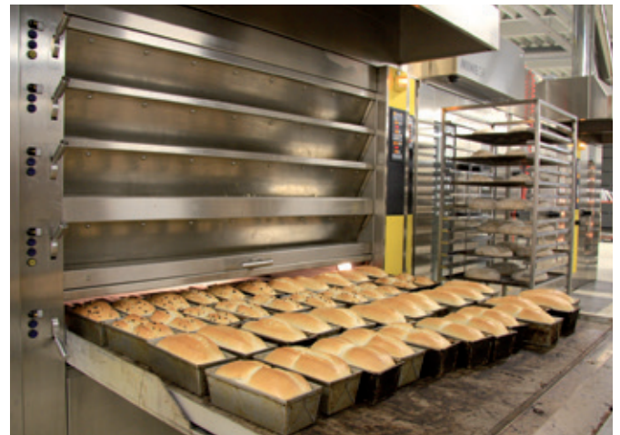
Der Auszugsherd des MIWE thermo-express erlaubt Kastenbrote leicht ein- und auszubringen. Selbst bei engster Belegung stimmt die Backqualität.
